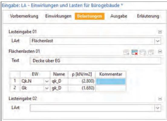
Die Software der mbAEC Gmbh bietet Ihnen die Möglichkeit, Lasten auf andere Bauteile und Module zu übernehmen. Wir erläutern nachfolgend die Vorgangsweise anhand eines einfachen Beispiels (Deckenplatte auf Stahlbetonstütze).
