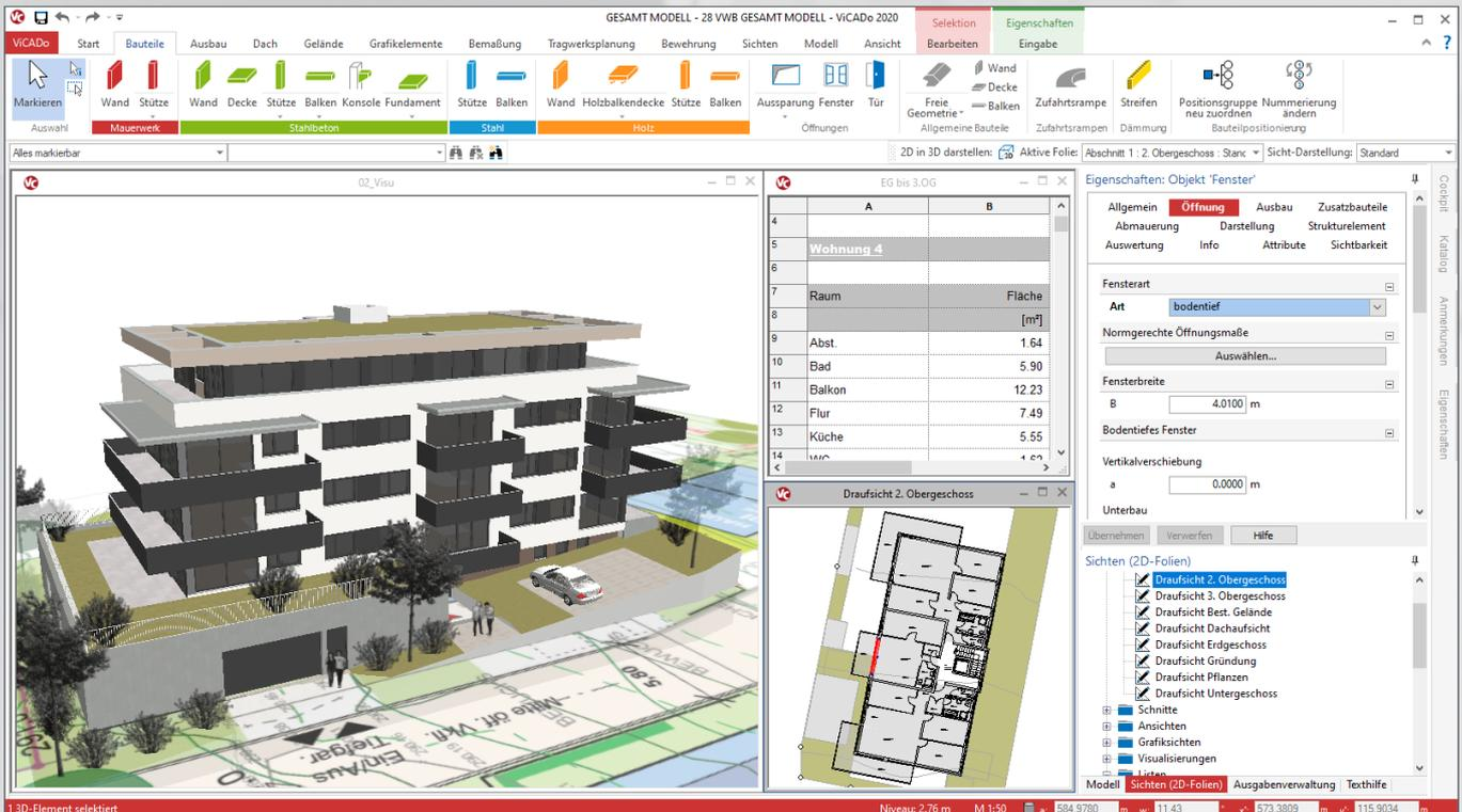
Dies ist der entscheidende Unterschied zwischen einem klassischen CAD-System und ViCADo: Sämtliche Zeichnungen und Mengenermittlungen werden aus dem einmal erstellten virtuellen Gebäudemodell entwickelt. In diesem Gebäudemodell, dem „digitalen Zwilling“, können in den einzelnen Bauteilen zusätzliche Informationen hinterlegt werden. Solche Informationen zum Detaillierungsgrad, zu Kosten oder zu Zeiten steigern die Dimension des Modells vom 3D- zum 5D- bzw. zum BIM-Gebäudemodell.
