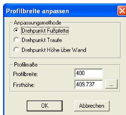
Hier kann z.B. die Profilbreite oder die Firsthöhe über die Dachneigung und ausgewähltem Drehpunkt geändert werden. Über den rechteckigen Schalter, hinter dem Eingabefeld der Firsthöhe, kann eine Draufsicht geöffnet werden, in dem durch Anklicken einer Dachkante oder einer Pfette deren Höhe abgegriffen werden kann.
