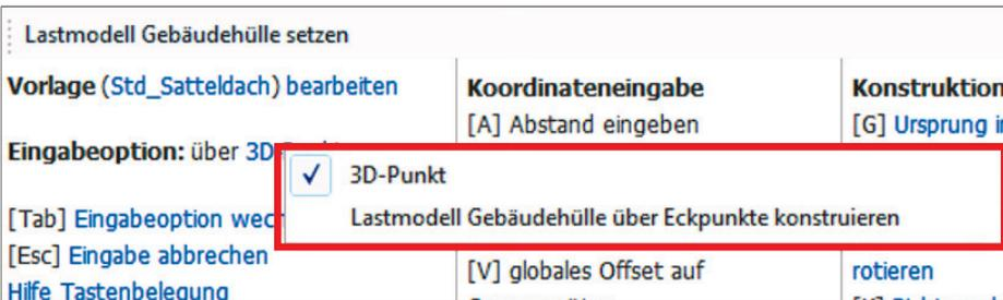
1. Sie beginnen mit der Eingabe der Gebäudehülle und definieren mit der Gebäudehülle die Abmessungen des Gebäudes. Dies kann als Konstruktionshilfe für alle weiteren Positionen, wie Fall- oder Stabwerke, dienen.
