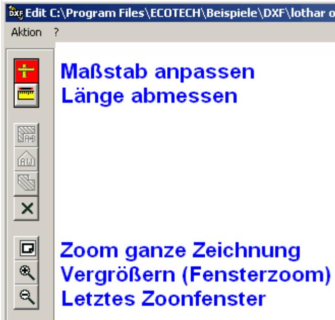
Nach dem Öffnen muß der Maßstab kalibriert werden, d.h. die am Bildschirm abgegriffene Länge muss mit der wahren Länge in Übereinstimmung gebracht werden.
