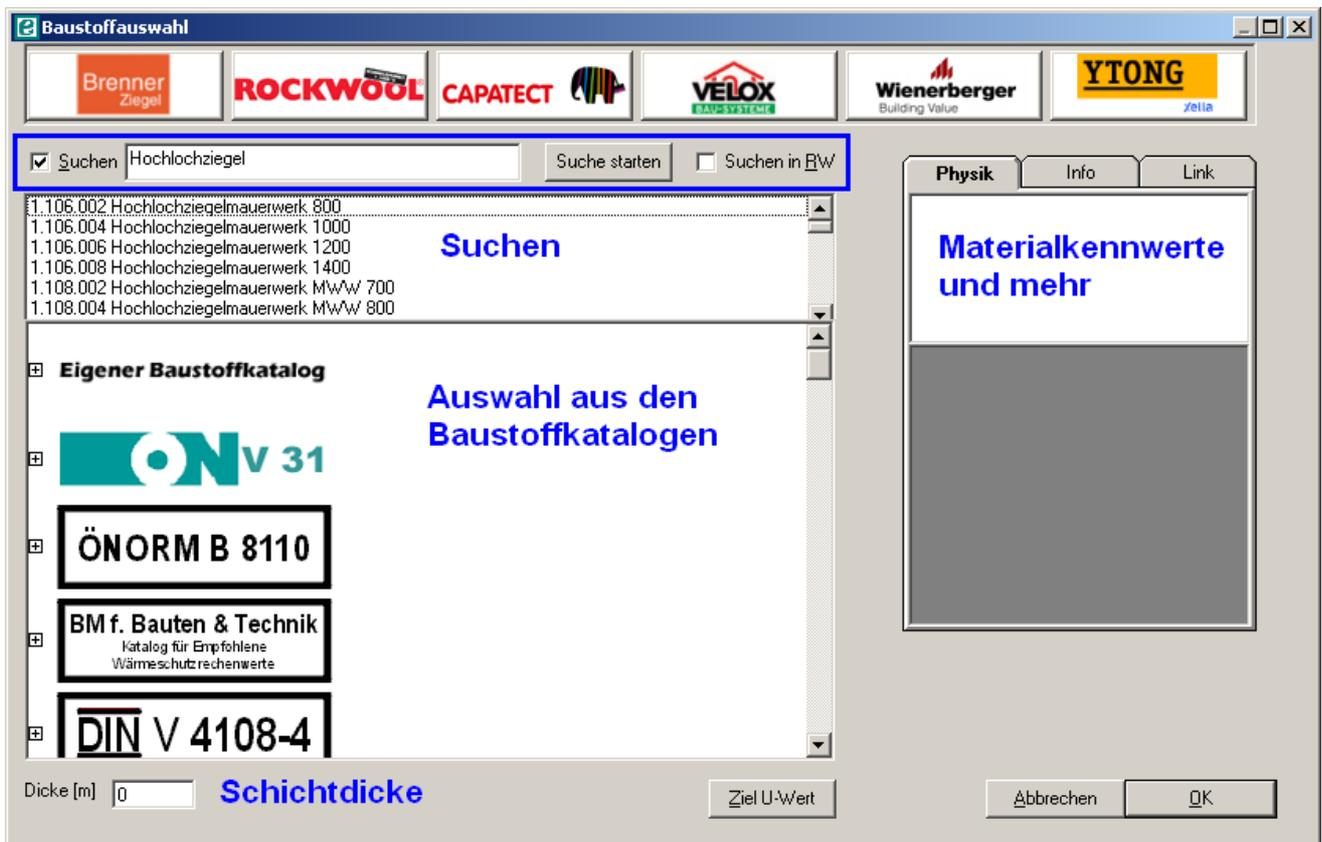
*Baustoffauswahl. Ein passendes Material kann über die Suchfunktion oder direkt aus den Katalogen ausgewählt werden. Rechts werden - wenn ein Material ausgewählt ist - physikalische Kennwerte, Produktinformationen, Links zu Datenblätter etc. angezeigt. Schichtdicke eingeben nicht vergessen!*
