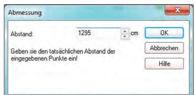
8. Das Bild wurde auf die richtige Größe skaliert und kann nun als Vorlage zum Zeichnen des Planes verwendet werden. Bilddateien (auch gescannte PDF-Dateien) sind Pixelgrafiken. Daher ist kein genauer Fangpunkt vorhanden und es kommt zu Abweichungen von einigen Millimetern. Je nach Qualität des Bildes und Genauigkeit der Eingabe, können diese Abweichungen sogar einige Zentimeter betragen.
