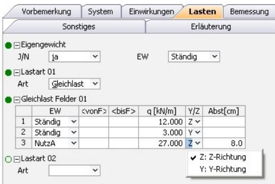
Das Programm berechnet und bemisst Einfeld- und Durchlaufsysteme mit oder ohne Kragarme aus Stahlbeton nach DIN 1045-1 [1]. Neben einem zweiachsigen Lastangriff können zusätzlich auch Normalkraft- und Torsionsbeanspruchungen berücksichtigt werden. Das statische System kann in vertikaler und horizontaler Richtung unterschiedlich definiert werden. Alle Einwirkungskombinationen der ständigen und vorübergehenden sowie der außergewöhnlichen Bemessungssituation werden automatisch gebildet.
