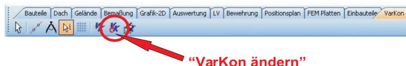
Sie befinden sich in der Planzusammenstellung, welche durch das VarKon generiert worden ist. Mit dem Befehl „VarKon ändern“ wird der Arbeitsbildschirm des VarKons dargestellt.
