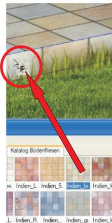
Stellen Sie hier "Fläche" ein, so wird durch Ziehen eines Materials (linke Maustaste) vom Katalog in das Projekt, die gewünschte Fläche ausgewählt und mit dem neuen Material belegt > wie in diesem Beispiel die vertikale Fläche der Terrasse.
