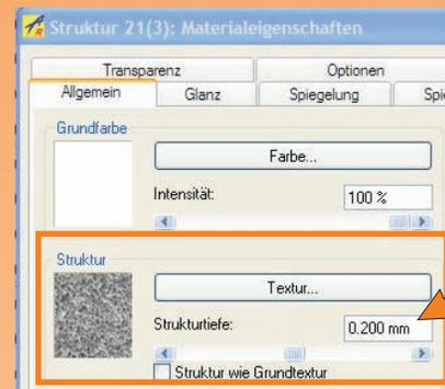
Durch das Einstellen der Spiegelung und der Strukturtiefe wird sogleich das Ergebnis visuell dargestellt. Indem die Strukturtiefe sehr fein eingestellt wird, wie hier 0,200mm, ändert sich das Material und es wird lediglich eine leichte Unschärfe in der Spiegelung wiedergegeben.
