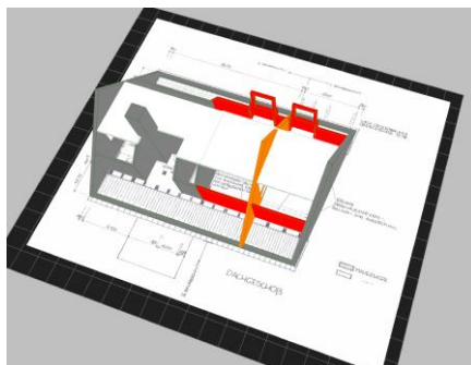
3D-Bauteile auf gescanntem Plan
