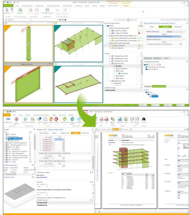
Mit dem Modul S009 werden Text- oder Tabellendokumente aus Microsoft Office direkt in das Statik-Dokument integriert.
